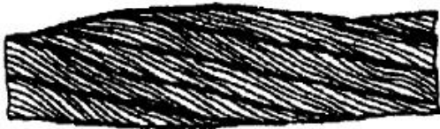
Рисунок 13. Местное увеличение диаметра каната.
